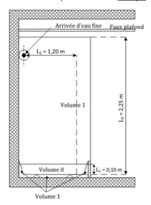
Ces volumes permettent de déterminer les emplacements à respecter pour les prises de courant ainsi que les tensions maximales à respecter. Il est question d'une protection contre les chocs électriques par contact indirect, sans coupure automatique de l'alimentation. Le
